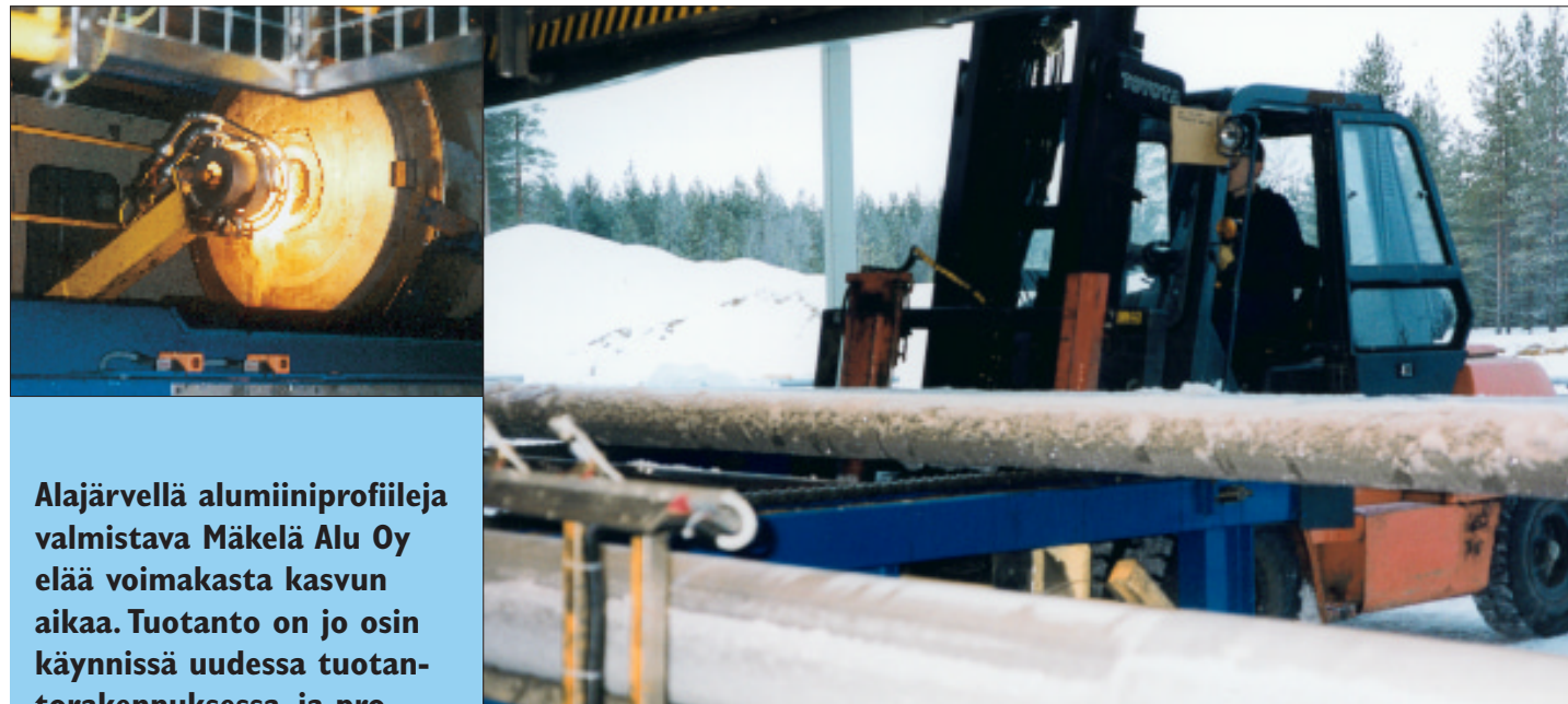
Ulkona varastoidut alumiinipihdit lämmitetään nestekaasulla ennen prosessia.
